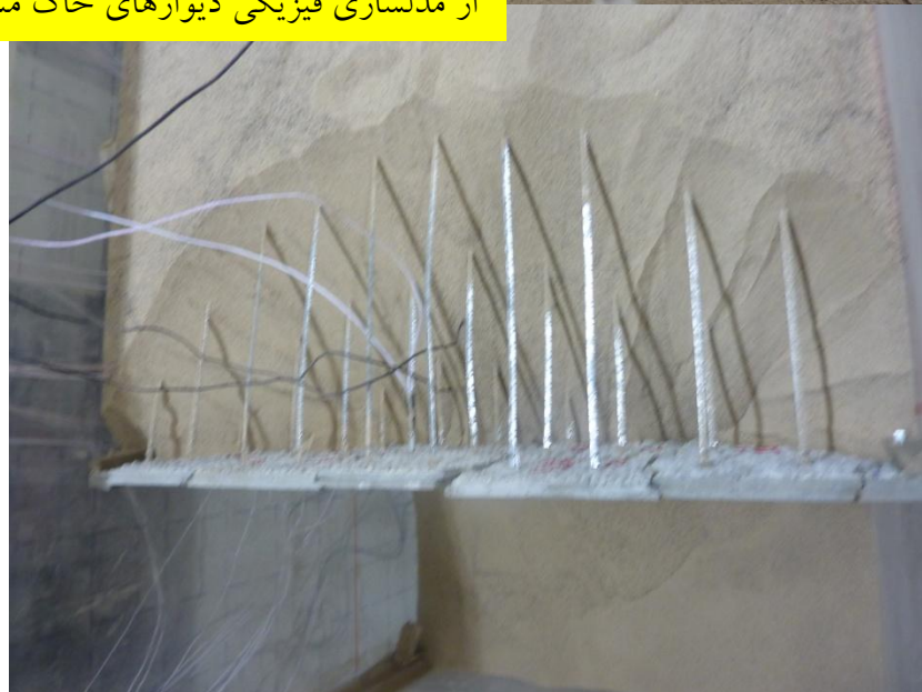
از مدلسازی فیزیکی دیوارهای خاک مسلح با تسمه فولادی
