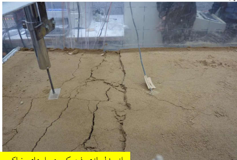
از مدلسازی فیزیکی دیوارهای خاک مسلح با تسمه فولادی
